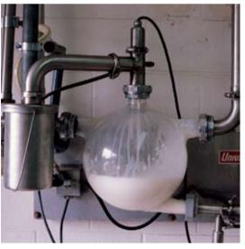
细菌和其它污染物的污染。 这就需要在过滤系统上配置除油除水除尘预过滤器。在使用过程中除菌滤器应该能够承受142°C (288°F)的蒸汽反复灭菌100次以上。 所有的过滤系统都确保达到或超过3A Accepted Practice 604-04中的质量要求。在无菌液态奶储罐上用于液态奶输送的空气除菌过滤器,为了满足高温高压蒸汽的反向灭菌,应使用不锈钢骨架支撑的BIO-X II 除菌滤芯。
